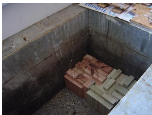
Figura 22 - Tanques para a imersão dos corpos de prova
