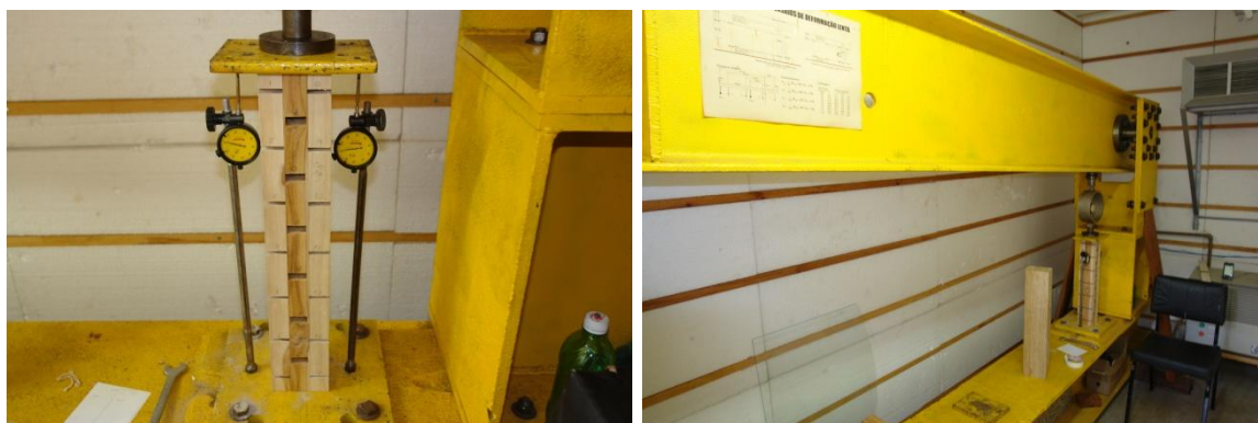
Figura 29 - Aparato de ensaio dos corpos de prova de fluência
