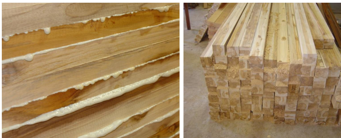
Figura 18 - Cruzetas de MLC prontas para furação, acabamento e tratamento
