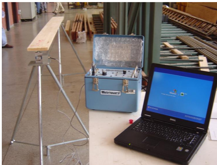
Figura 10 – Equipamento de vibração transversal utilizado nos testes.
