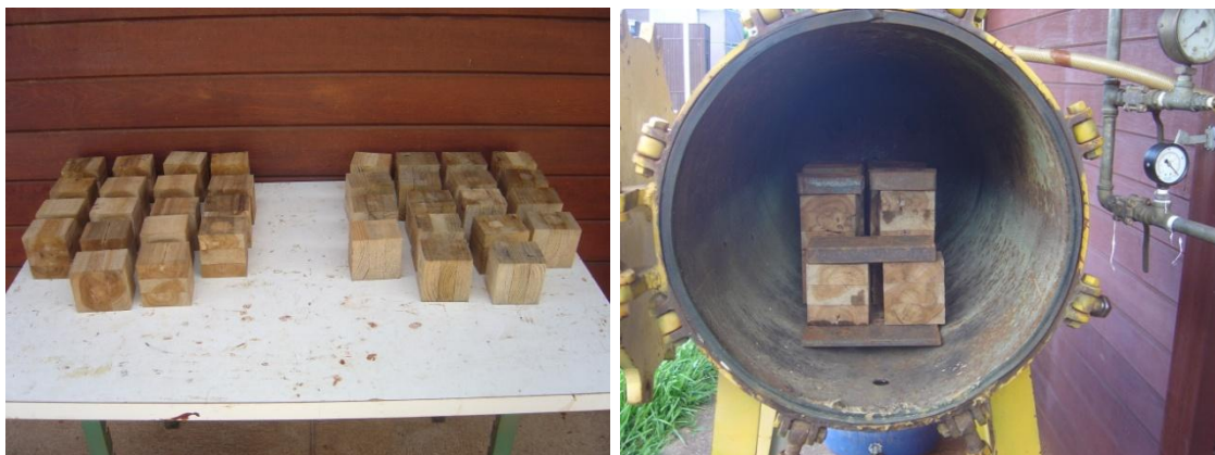
Figura 26 – Corpos de prova de delaminação retirados das cruzetas de MLC e ensaio na autoclave
