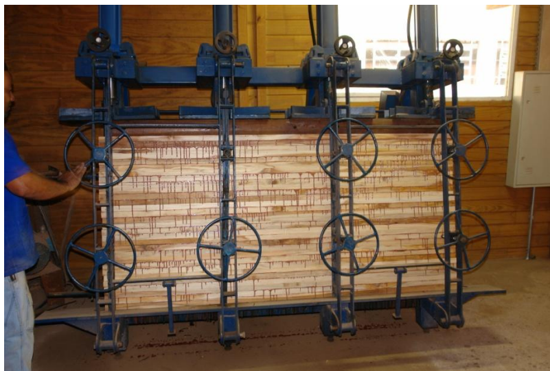
Figura 17 - Prensagem das cruzetas de MLC
