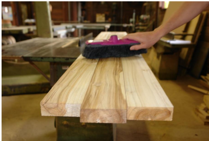
Figura 13 - Limpeza das lamelas para aplicação do adesivo
