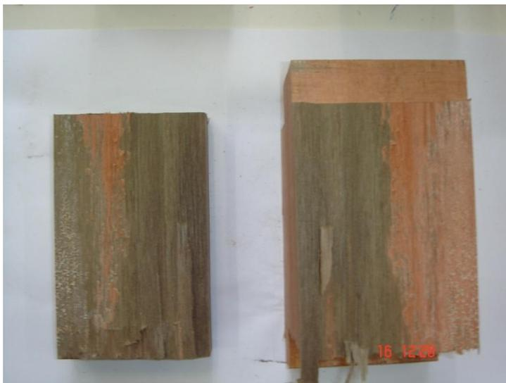
Figura 11 – Modo de ruptura por cisalhamento de Lyptus sem tratamento.
