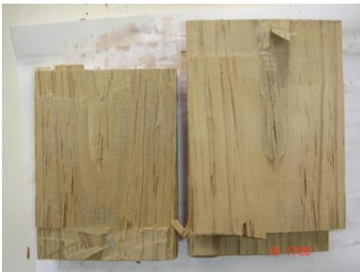
Figura 8 – Modo de ruptura por cisalhamento de *Pinus* sem tratamento.
