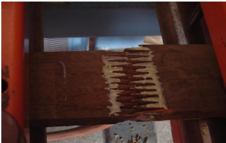
Figura 14 – Ruptura da emenda dentada de *Eucalyptus grandis* após colagem, tratamento preservativo e secagem.
