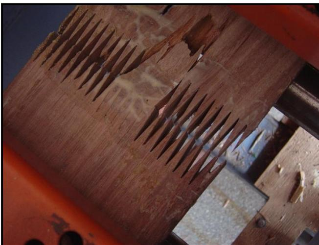
Figura 12 – Ruptura da emenda dentada de Lyptus após colagem durante o ensaio de tração paralela às fibras de madeira.
