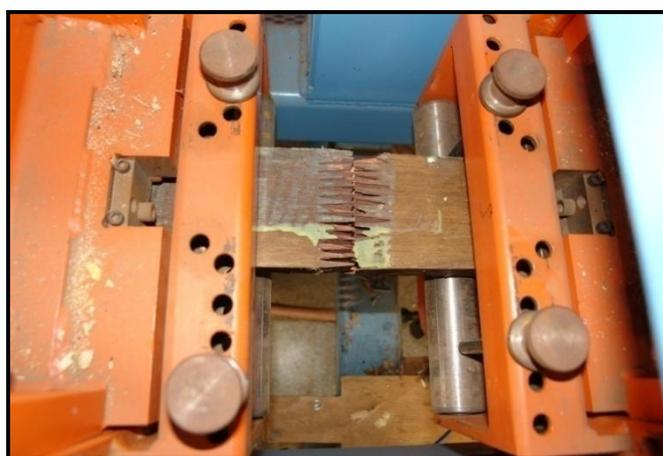
Figura 13 – Ruptura da emenda dentada de Lyptus após colagem, tratamento preservativo e secagem durante o ensaio de tração paralela às fibras da madeira.
