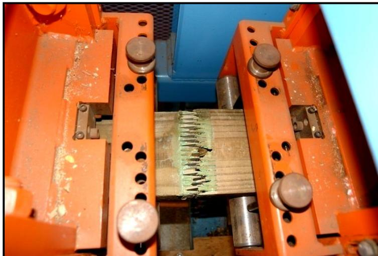
Figura 10 – Ruptura da emenda dentada de *Pinus* após colagem, tratamento preservativo CCA e secagem durante o ensaio de tração paralela.
